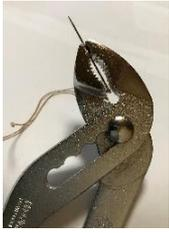
糸を通した丸針をプライヤー先端で挟み皮の糸穴に押し込むと力が入り、針が通しやすくなります。注意点は針の先は短く出す事、針先がプライヤーから長く出た状態だと針が曲がったり折れたりする。場合によっては手に突き刺さったりして非常に危険なので注意して行ってください。
