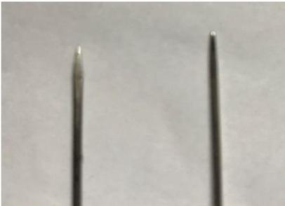
下写真の左が皮用縫い針、右が丸針。写真は不鮮明で分かりづらいがそれぞれの先端部。丸針の先端は尖ってはいないが縫い針は槍の穂先のように断面は三角になっている。三角の角が刃のようになっており細い下穴に糸を通していく時に先に通っている糸を切ってしまう事がある。また針を引く際に指先を三角のエッジで切る事が多い。
