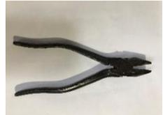
この写真の道具は「ウォーターパイププライヤー」というもの。水道屋が水道管の付け替えなどに使っています。普通のペンチやプライヤーは真っすぐだが、これは挟む部分が握る柄に対して斜めになっている。この角度が意外と細かい作業にも適しているので重宝しています。皮は厚みもありそれなりに硬い、皮を組み合わせて切れ目に差し込んで引き抜いたりする作業が楽になります。皮を縫い合わせる時にも針を差し込むのに先に針を挟み押し込む、あるいは針の先端は出ているのに抜けない時に挟んで引き抜くといったように使います。作業効率が良くなります。
