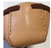
**ヒモ締めタイプカカト部割り付け図** ・割り付けする時に真後ろ部を長くする。(この場合7cm)
