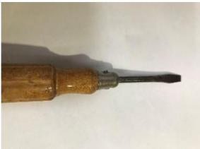
ヒダを締めるために皮ヒモを通していくが、ヒダの切れ目は切ったままでは閉じている状況なので皮レース針を使っても通しにくい場合が多い。そこで切れ目を必要に応じて少し広げた方が作業がスムーズ、マイナスドライバーを手元に置いておくと便利です。先端を切れ目に差し込んで押し込む、必要に応じて回すようにして切れ目を広げるという使い方です。ドライバーは家庭に備えている事は多い、作業の手元に置いてください。
