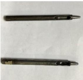
なくても何とかなるがあった方が便利でしょう。足首ベルトのバックルピンが入る穴を開ける。千枚通しで突いてもOKだが突き刺すのは厳密に言えば「不揃いに切っている」状態です。これを使えば「穴を切り取る」事ができ、ベルトが長持ちします。またオパンケつま先に部品の舌を付ける際にこれで5mmの長さで少し巾のある溝穴を開ければ皮ヒモが通しやすくなる。詳しくは6ページの作り方説明を見てください。
