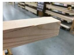
材料はホームセンターで手に入ります。板はカットしたものがあるので近い寸法のを、木の棒は「土木用の杭」で長さが近いものを選ぶ。材質は米松(ベイマツ)と言えば分かる、杭の材質はたいていがこの米松です。(右の写真)杭なので先端は尖っているが、その部分はノコギリで切り落としてしまう。左イラスト上の赤い◎の所で丁番で止めるのは
