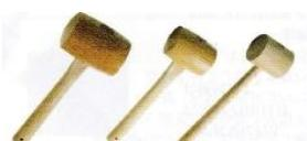
本体皮に糸を通したりする下穴を開ける際に千枚通しを叩くのに必要。千枚通しを手で押すよりは正確な位置に皮面に対して真っすぐに開けらる、ハンマー(金づち)でもやれなくはないが打撃面が大きいので良好。いわゆるプロの職人は木づちを必要に応じてよく使います。
