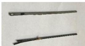
ヒダに皮ヒモまたはスニーカーヒモを通していく時に非常に便利。針の元がバネのように二枚に分かれており、そこに皮ヒモの端を挟む事が出来るようになっている。オパンケのヒダにヒモを通す時に重宝。写真では見えないが二枚に分かれた内側中に上向きの小さなツメがありこれが皮ヒモの表面に食い込むのでヒモが抜けにくく出来ています。
